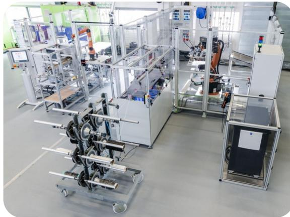
Die Freiheitsgrade eines 6-Achs-Industrieroboters und die garnbasierten Faserhalbzeuge erlauben eine präzise physische Nachbildung topologieoptimierter Strukturen mit lastpfadoptimierter Faserausrichtung.
